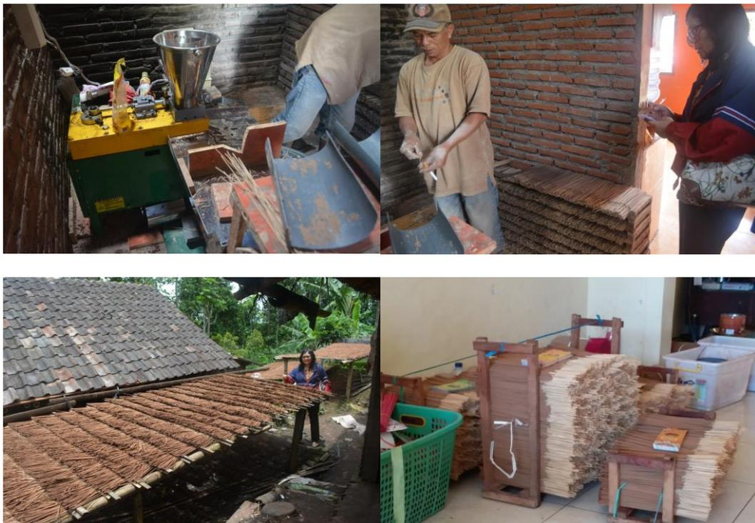
**Gambar 2.** Pembuatan Dupa Aneka Warna dengan Mesin Mixer
