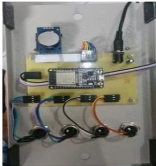
Gambar 4. Rangkaian *weather station* yang telah disusun
